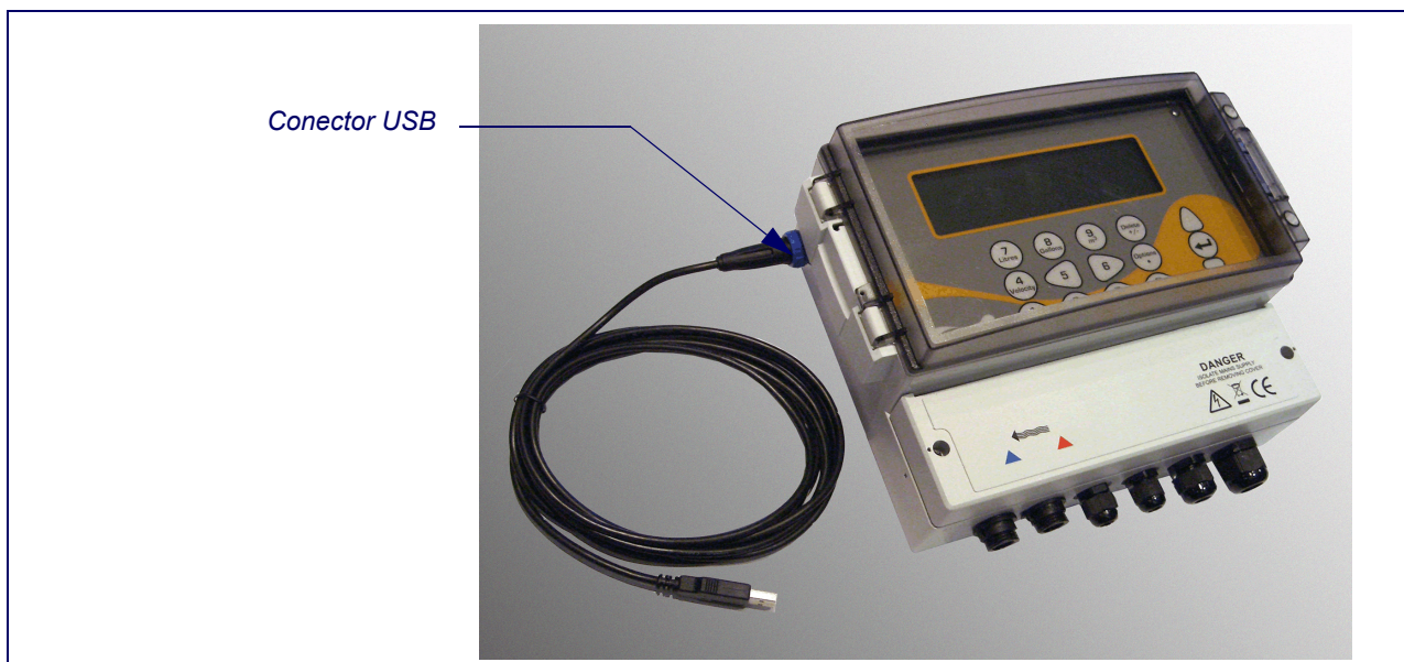
Figura 2.2 Conexión USB en el instrumento U4000
